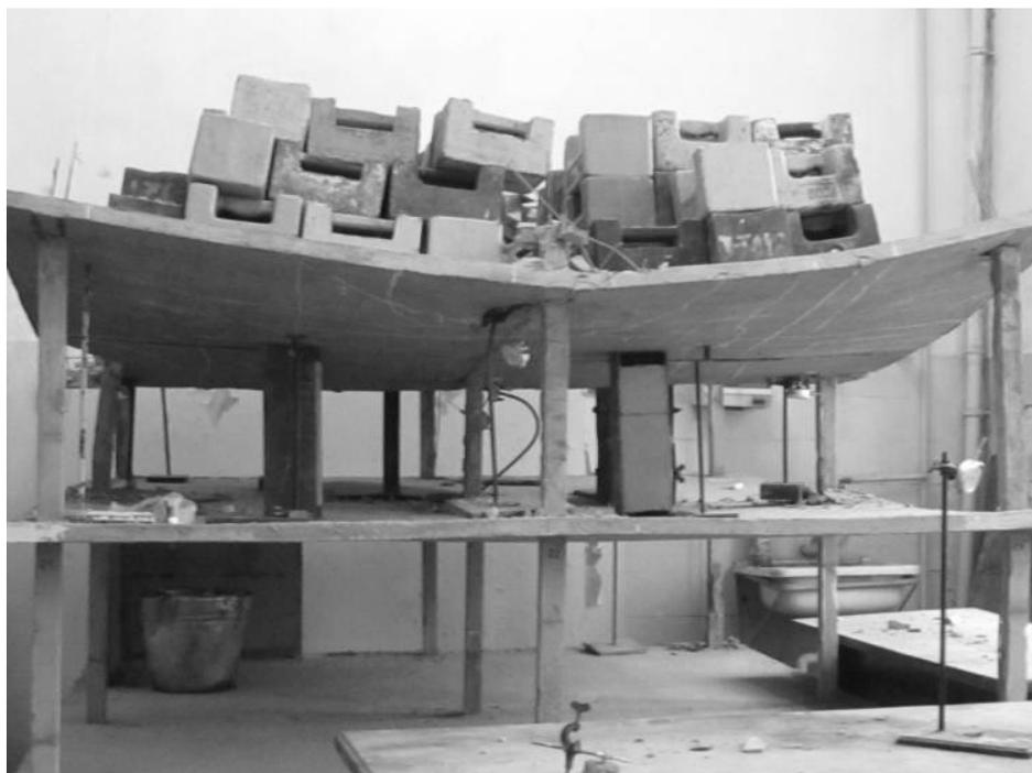
Рис. 6. Общий вид разрушения каркаса
